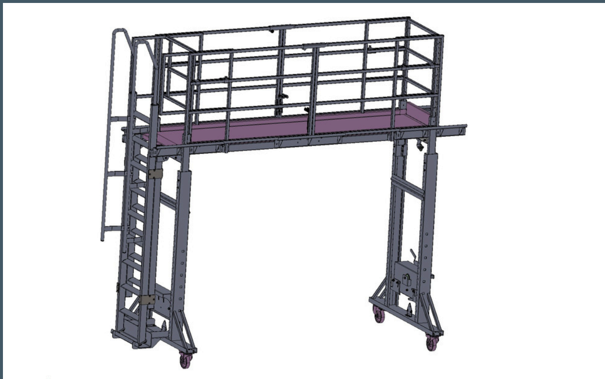
Plateforme en position basse, échelle repliée et garde-corps fermés
