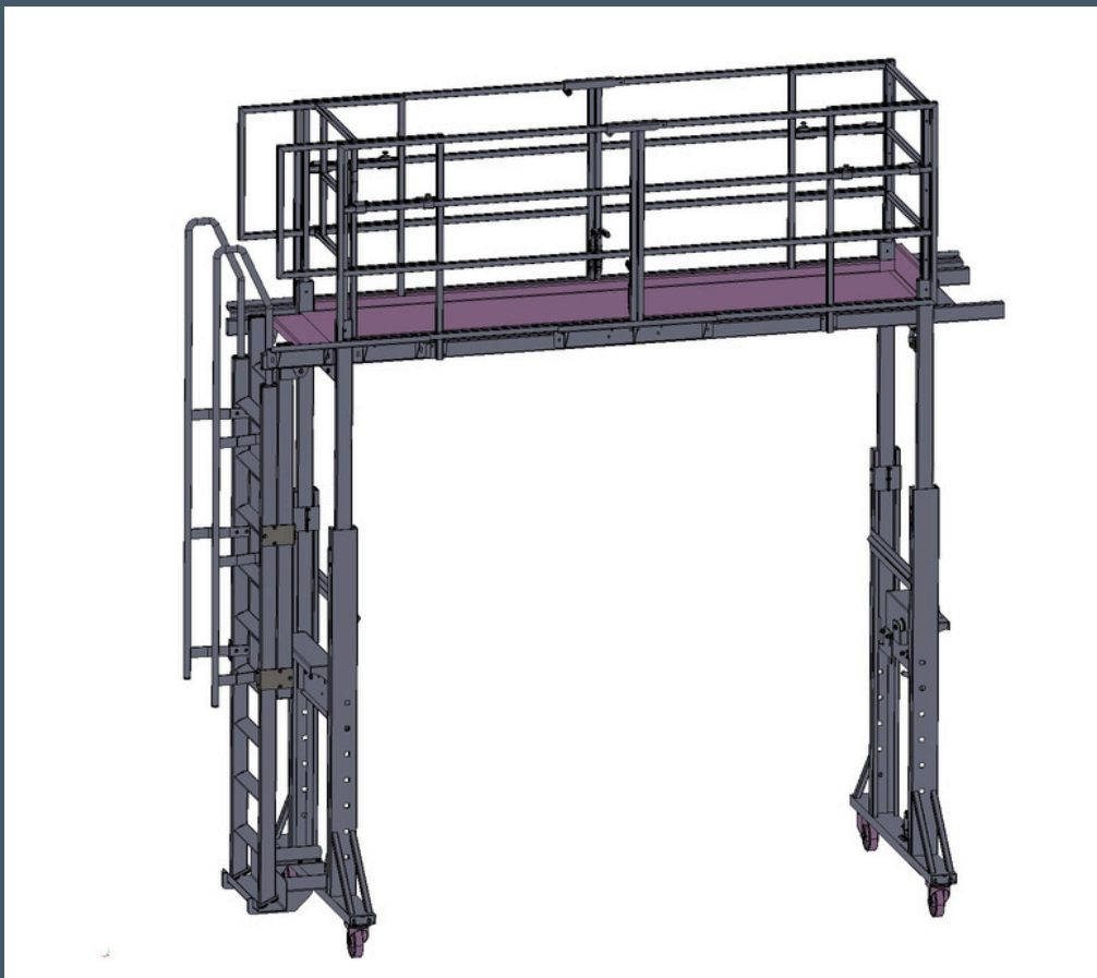
Plateforme en position haute, échelle repliée et garde-corps fermés
